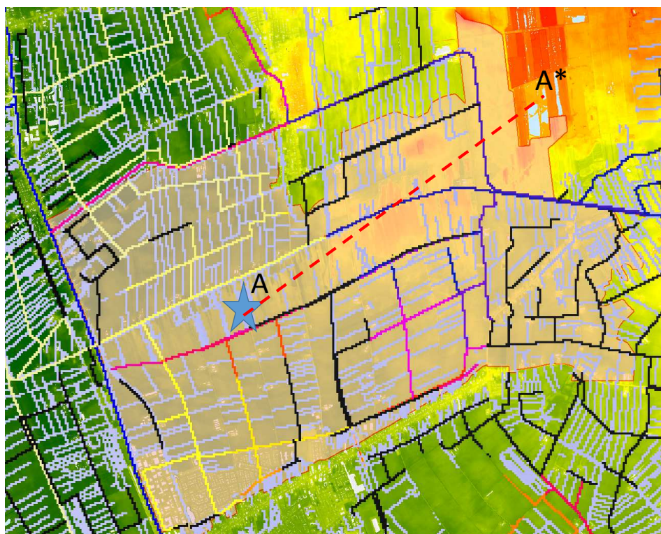
Figuur 6: Oppervlaktewatersysteem Vriezenveen met wateraanvoergebied en maaiveldverloop
